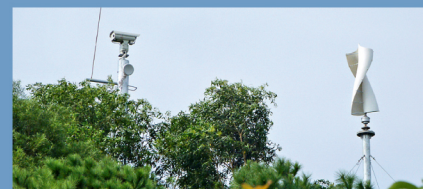
視野智能森林火險監控系統由紅外線攝像儀、透霧攝像儀等整合而成，可快速尋找可疑熱源，並即時通報。
