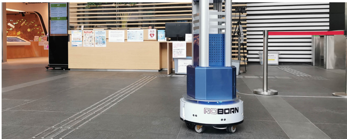
▲ 路邦的 IEQ 機械人獲政府機電工程署採用，幫助監測室內環境質素。
