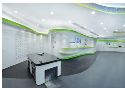
▲ 2012 年葉憬翰接手重新設計旺角郵政局，書寫枱面驟眼看像兩道一長一短的波浪，實質較高一層適合站立書寫，下層枱面則方便坐輪椅傷殘人士使用，可見他的匠心設計。
