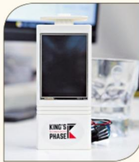
由於傳感器愈大，加熱時間愈長，容易影響數據準確性，加上市場需要，故生酮吹氣機內至芯片，外至機身設計，都要細。（湯致遠攝）
